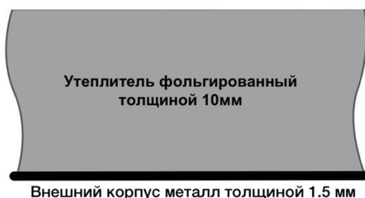
Рис. 1 Схема утепления шкафа
