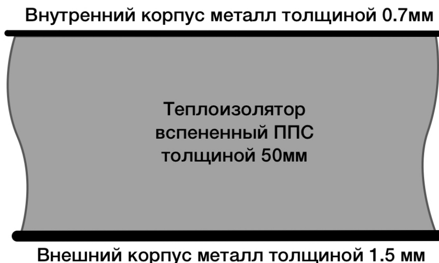
Рис. 1. Утепление шкафа по принципу «сэндвич панель»
