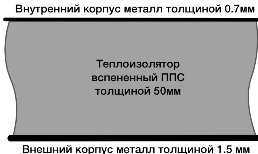
Рис. 1. Утепление шкафа по принципу «сэндвич панель»
