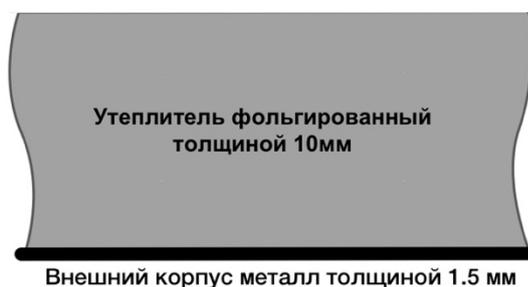
**Рис. 1 Схема утепления шкафа**
