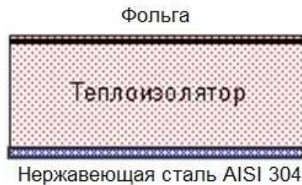
Рис. 1. Строение стенки рабочего пространства шкафа
