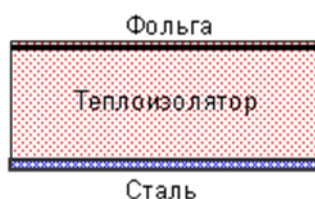
Рис. 1. Строение стенки рабочего пространства шкафа
