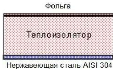
Рис. 1. Строение стенки рабочего пространства шкафа
