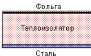
Рис. 1. Строение стенки рабочего пространства шкафа
