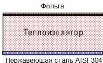
Рис. 1. Строение стенки рабочего пространства шкафа
