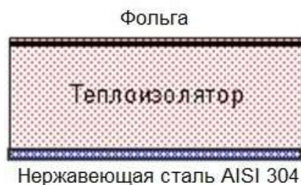
Рис. 1. Строение стенки рабочего пространства шкафа
