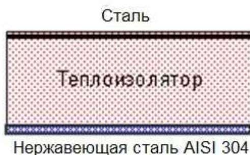
Рис. 1. Строение стенки рабочего пространства шкафа
